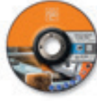
ОТРЕЗНОЙ ДИСК Для отрезания стальных листов, труб и профилей на хорошей скорости и при хорошей стойкости. Универсально используется для стали и высококачественной стали. Форма с уступом, внутренний диаметр 22,23 мм, максимальная скорость вращения 12 250 об/мин, максимальная рабочая скорость 80 м/с.
