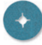
ВОЛОКОННЫЙ ШЛИФОВАЛЬНЫЙ ДИСК Высокопроизводительное шлифовальное средство из циркониевого корунда с очень хорошими производительностью съема металла и сроком службы. Универсально используется для стали и высококачественной стали.
