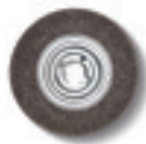
ПРОВОЛОЧНАЯ ЩЕТКА Ø 250 x 60 мм, с высокой прочностью проволоки для особенно экономичного применения, крепежное отверстие Ø 51 мм. Проволока толщиной 0,2 мм для тонкостенных труб и профилей. Проволока толщиной 0,35 мм для универсального применения. Проволока толщиной 0,5 мм для толстостенных труб и профилей и эффективного удаления заусенцев. Исполнение из стали
